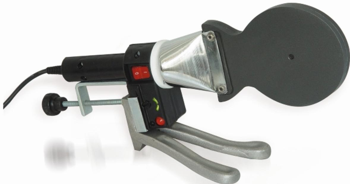
این ابزار جهت جوش لوله و اتصالات پلی اتیلن به روش سربه سر مورد استفاده قرار می‌گیرد. این ابزار از جنس آلومینیوم با روکش نقلون صنعتی و در سایزهای ۳۱۵، ۲۵۰، ۲۰۰ و ۱۶۰ تولید می‌گردد. درجه نصب شده بر روی دستگاه فیز جهت نشان دادن حرارت مورد نظر می‌باشد. این هیتر با یک کپسول ۵ یا ۱۱ کیلوگرمی گرم می‌شود.
