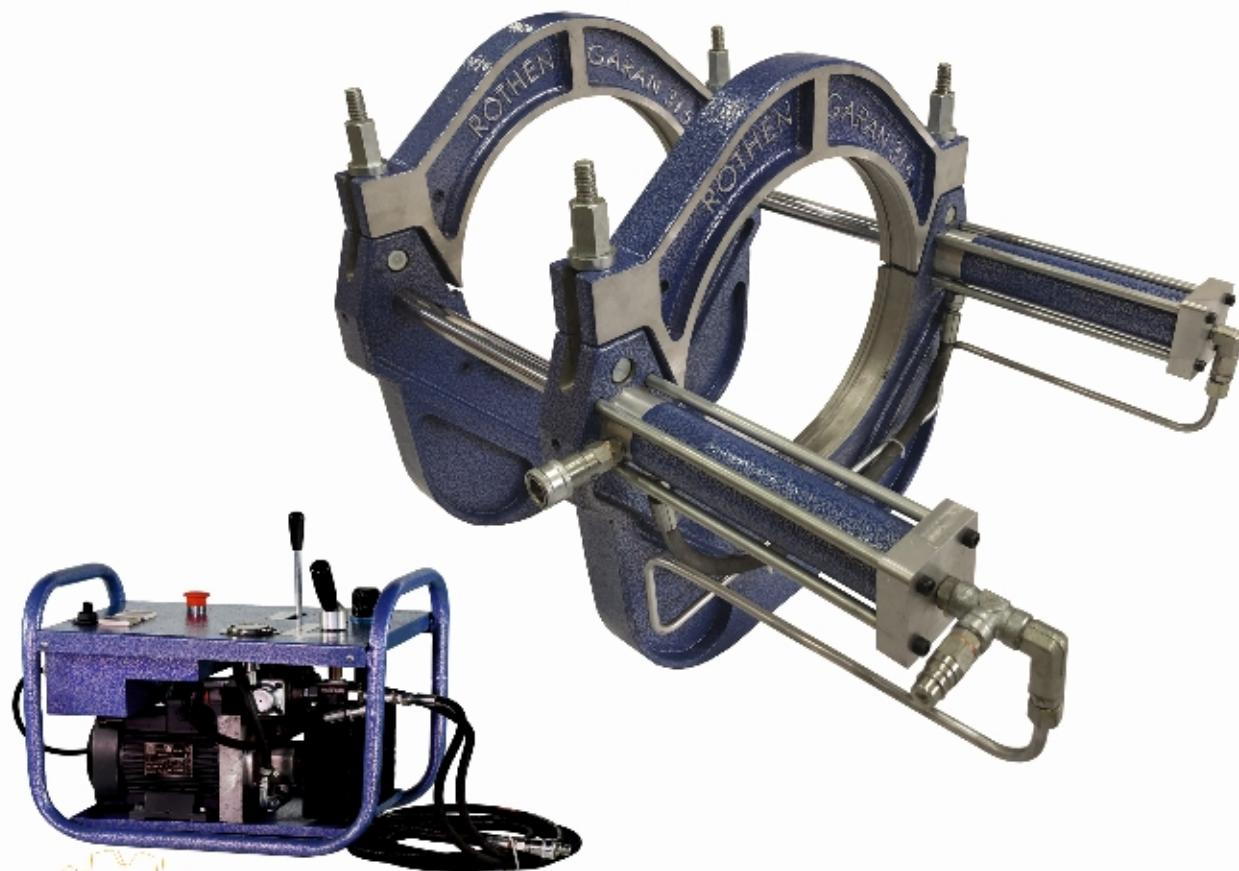
• این دستگاه که قسمتی از وسایل جوش بلی اتبیان می باشد جهت حرکت دادن جکهای هیدرولیک دستگاه مورد استفاده قرار می گیرد.
